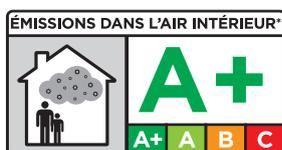
\*Information sur le niveau d'émission de substances volatiles dans l'air intérieur, présentant un risque de toxicité par inhalation, sur une échelle de classe allant de A+ (très faibles émissions) à C (fortes émissions).
