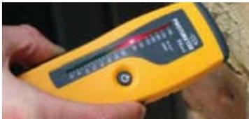
Très performant, il suffit de piquer les pointes dans le matériau. Une diode en couleur indique instantanément sur l'échelle graduée les possibilités de pose.
